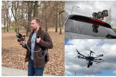
شکل ۳. سکویهای مختلف برای نصب اسکنر ZEB HORIZON
