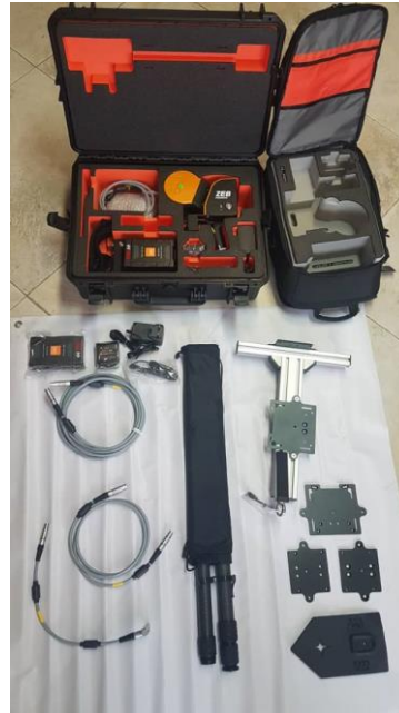
شکل ۲. اسکنر ZEB HORIZON و ملحقات آن، خریداری شده توسط دانشگاه بوعلی سینا
