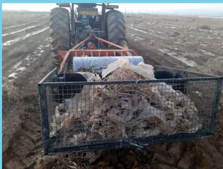
دستگاه جمع کن خودکار مالچ پلاستیکی نازک تولید شده توسط شرکت آتیه طراحی ماشین تارا
